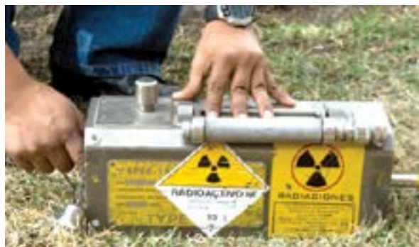
Fuente sellada utilizada en el análisis no destructivo de soldaduras como tuberías de agua y gas.
