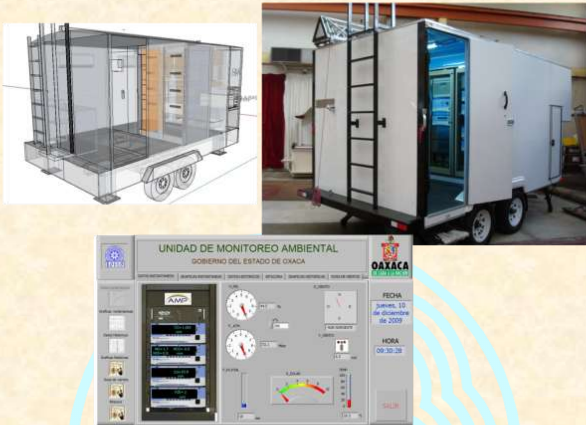
Unidad de monitoreo de la calidad del aire para la medición de SO 2 , H 2 S, NO x , CO, O 3 , PM 10 , PM 2.5 y de las condiciones meteorológicas: Gobierno del Estado de Oaxaca
