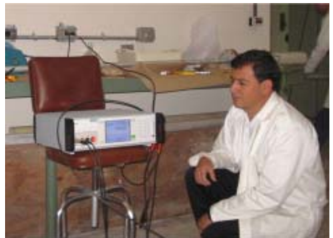
Revisando la resistencia de aislamiento de los detectores de fisión de intervalo amplio de los canales NM-1000 después de haber sido reparados
