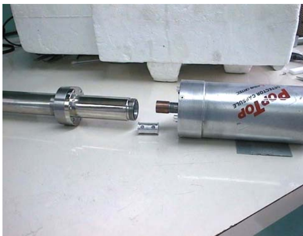
Figura que muestra la cápsula de criba molecular que se encuentra entre el dedo frío y el crióstato, de un detector tipo POPTOP.
